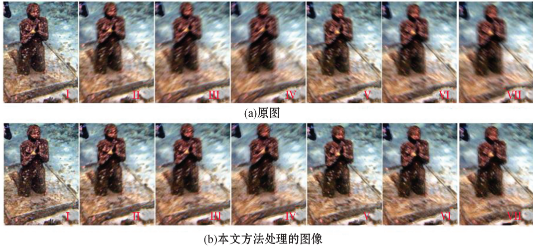
注:图 a 和图 b 中 I~VII 图像基于不同的模糊参数生成,即长度(dpi)和角度( ^{\circ} ), I (0 dpi, 0^{\circ} )、II (20 dpi, 40^{\circ} )、III (30 dpi, 40^{\circ} )、IV (40 dpi, 40^{\circ} )、V (20 dpi, -40^{\circ} )、VI (30 dpi, -40^{\circ} )、VII (40 dpi, -40^{\circ} )。
